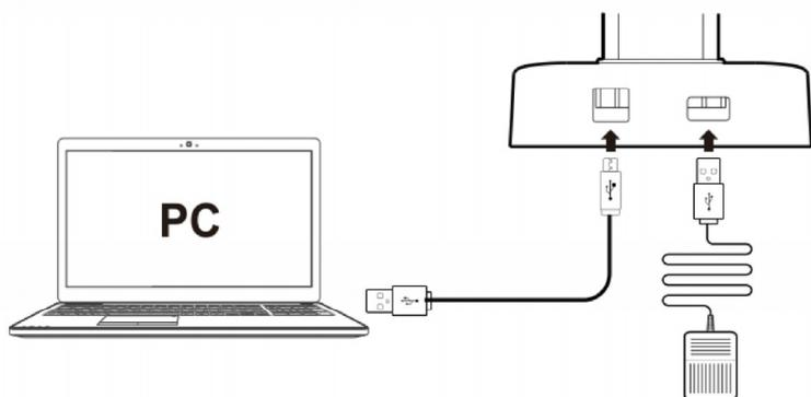
1. Подключите сканер к компьютеру используя USB кабель из комплекта поставки.
